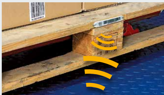
Niezawodna transmisja danych na najkrótszym dystansie między czytnikiem a transponderem RFID
