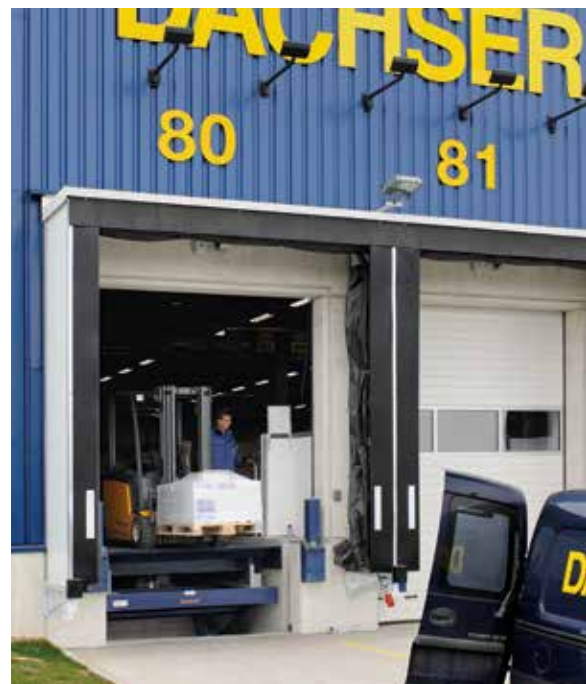
Liftleveller jest połączeniem rampy przeładunkowej z wysuwaną klapą i podnośnika nożycowego
