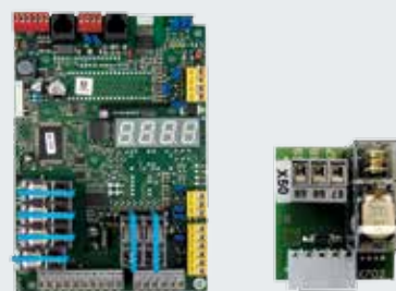
Płytki do rozbudowy elektronicznej sterowań: BK 150 FU E-1 (E FU H) AK 500 FUE-1 (E FU H)
